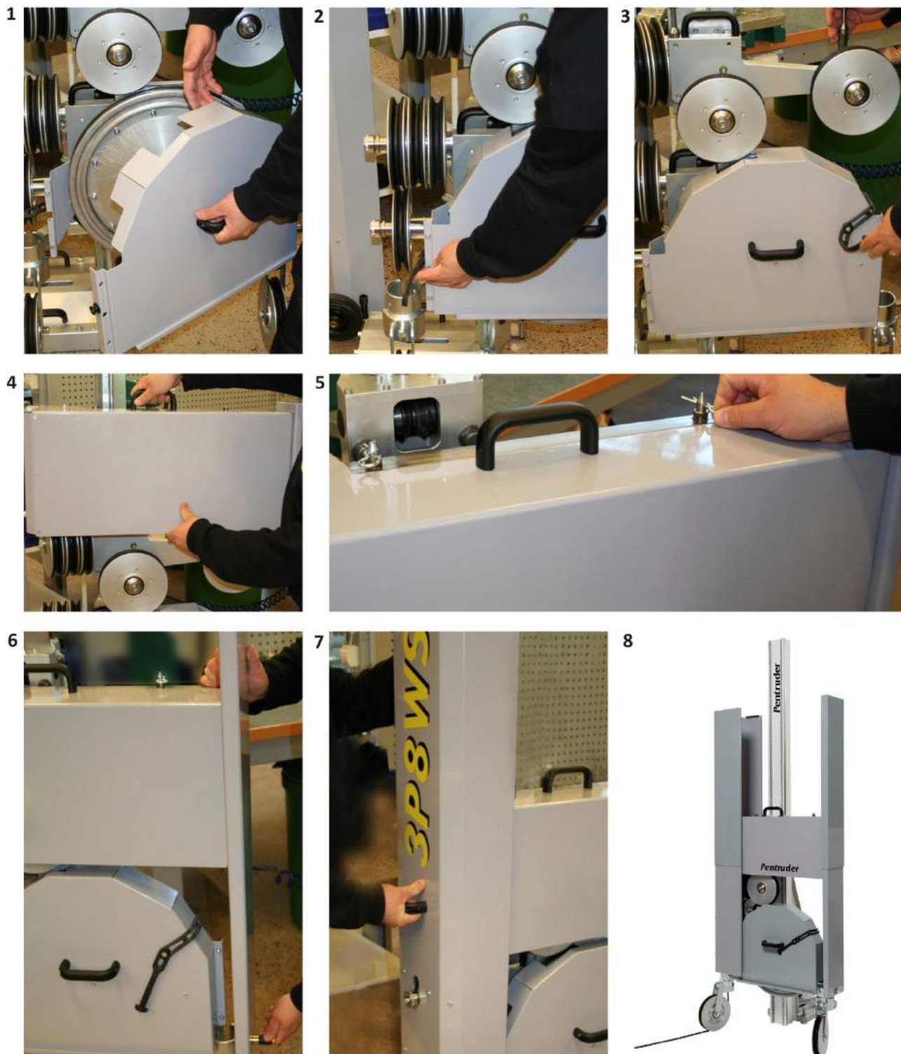
Монтаж защитных кожухов на канатной машине Pentruder 3P8
