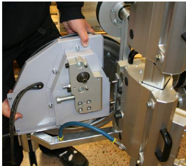
Монтаж узла главного приводного шкива
