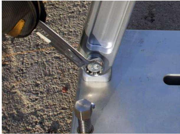
g. Подтяните нижний болт на заднем упоре.
