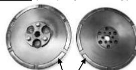
Одна поверхность сцепления: Затянуть динамометрическим ключом до **40 Нм**. Должны храниться чистыми и сухими.
