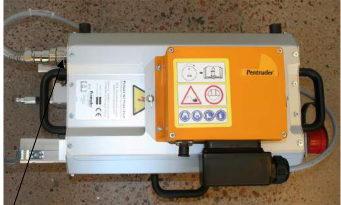
Разъем для пульта управления Приемник на верхней крышке Pentpak (на изображении приемник от WRC-HF)
