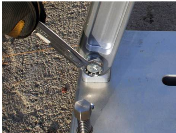
б. Ослабьте нижний болт на заднем упоре.
