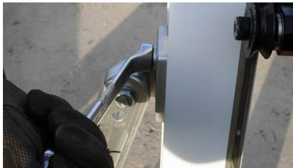
е. Когда направляющая окажется в правильном положении, затяните болт как следует.
