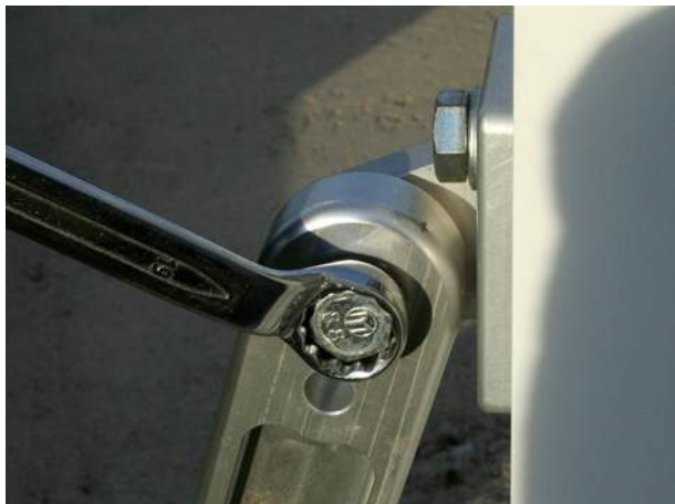
а. Ослабьте верхний болт на заднем упоре.
