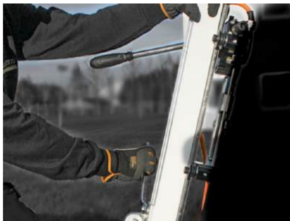
д. Затяните болт на нижней распорке и верхний и нижний болт на заднем упоре.
