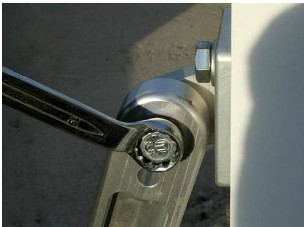
ф. Затем затяните верхний болт на заднем упоре.
