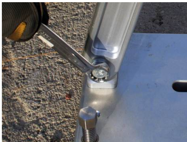
г. Затяните нижний болт на заднем упоре.
