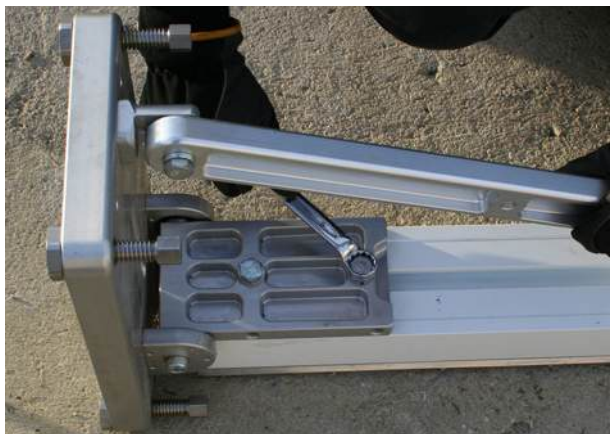
с. Затяните два болта на нижнем зажиме.
